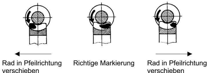
Durch Kontrolle der Lage des Tragbildes im eingebauten Zustand lässt sich erkennen, ob ein Einbaufehler bezüglich der axialen Stellung des Schneckenrades vorliegt. Das Tragbild sollte möglichst zur Auslaufseite tendieren. Bei wechselnder Drehrichtung (Reversierbetrieb) sollte das Tragbild zur Mitte tendieren.
