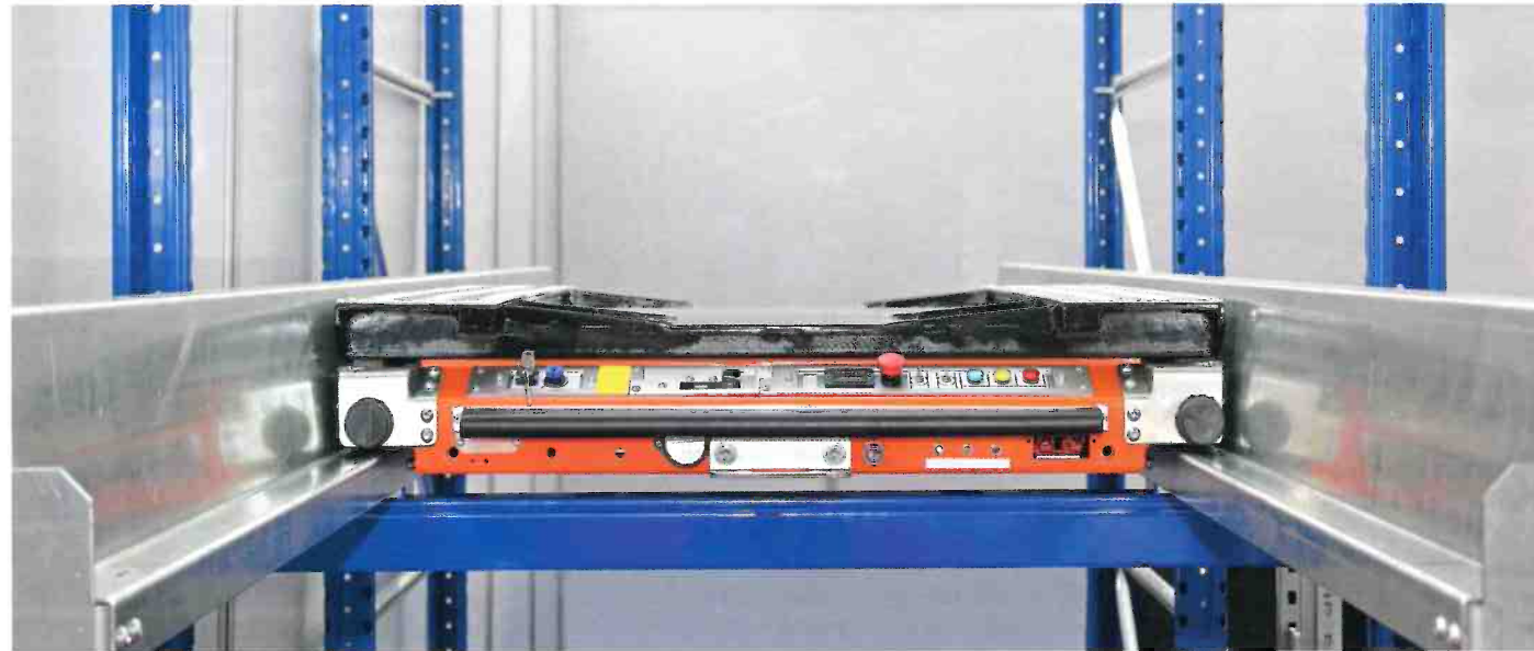
Die neue Getriebeausführung hat vor allem Vorteile für die in Shuttle-Fahrzeugen häufig eingebauten Rad- und Zahnriemenantriebe.
