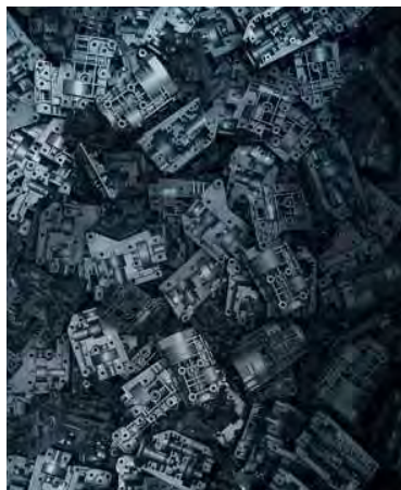
Diese Antriebsgehäuse werden bei Morat aus thermoplastischem Kunststoff hergestellt
