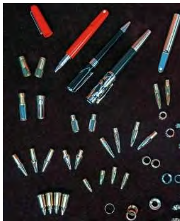
Teile für Schreibgeräte werden bei der Firma A. Weckermann durch Diamantieren ultraglatt
