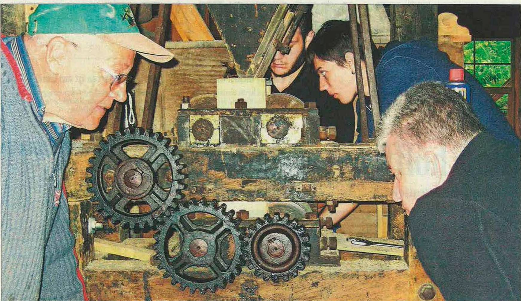
Die Azubis von Framo Morat brachten am Dienstag die Öhlermühle wieder in Betrieb. Das Foto zeigt (von links) Öhlermühlenbesitzer August Fürderer, die zwei angehenden Industriemechaniker Abbas Nehme und Manuel Hug sowie Ausbildungsleiter Holger Schwaab beim Einbau der beiden Kegelräder in den Walzenstuhl.
