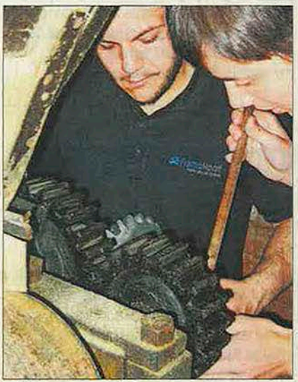
Einbau der mit den neuen Zähnen versehenen Kegelräder.
