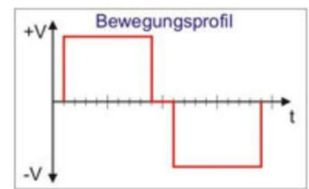
Für Anwendungen mit definierter Endposition in beiden Drehrichtungen, abgesichert durch 2 Sicherheits-Endschalter, ohne Wendeschutz.
