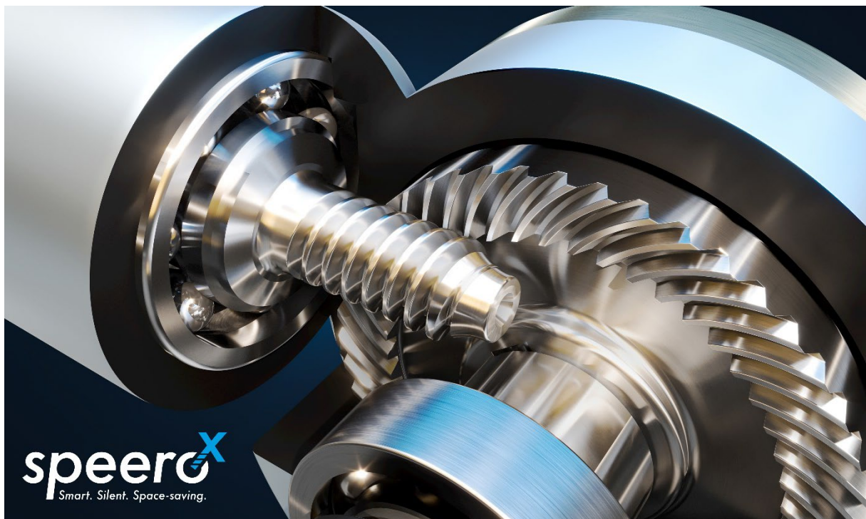
Durch den Einsatz der speeroX-Verzahnung lässt sich mit nur einer Getriebestufe eine hohe Performance erzielen. Dies resultiert im Vergleich zu klassischen Getriebevarianten in einer Verringerung von Gewicht und Bauraum. (Bildquelle: Franz Morat Group)
